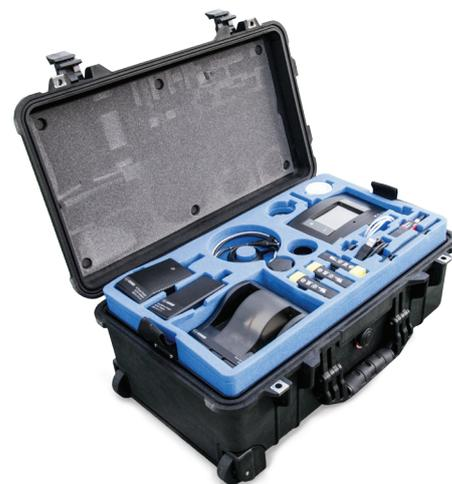
Das K5 wird mit einem neuen robusten, wasserdichten Profikoffer geliefert. Das Gehäuse verfügt über zwei Fächer zum Trennen nasser Gegenstände von den elektrischen Komponenten.
