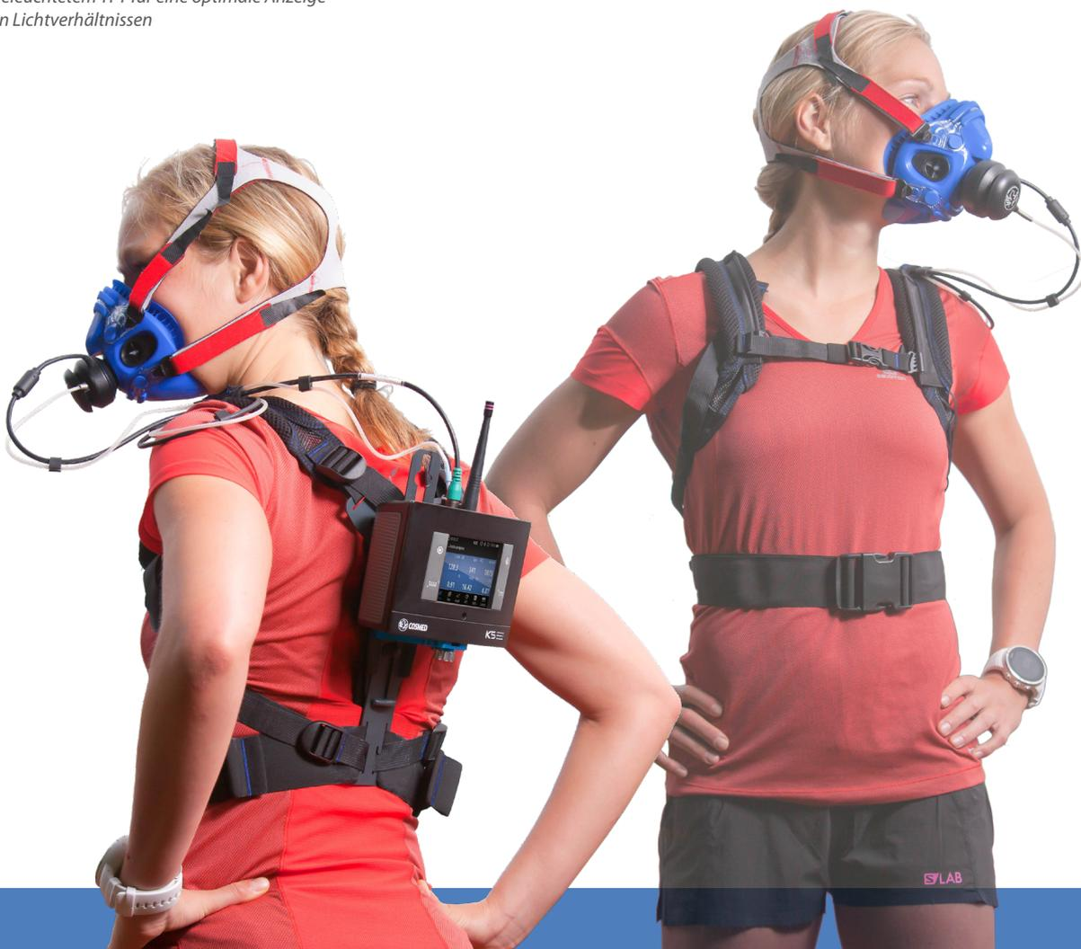
“ Das K5 entspricht der IP54-Norm, wurde speziell für den Außenbereich entwickelt und bietet Schutz vor Wasser (Regen, Schweiß) und Staub „
