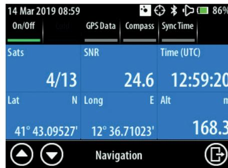
Les données GPS peut être surveillées en temps réel ou téléchargées vers un logiciel de cartographie.
