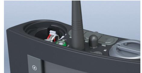
La sostituzione del sensore O<sub>2</sub> e/o della batteria è semplice e non richiede l'ausilio di alcun attrezzo.
