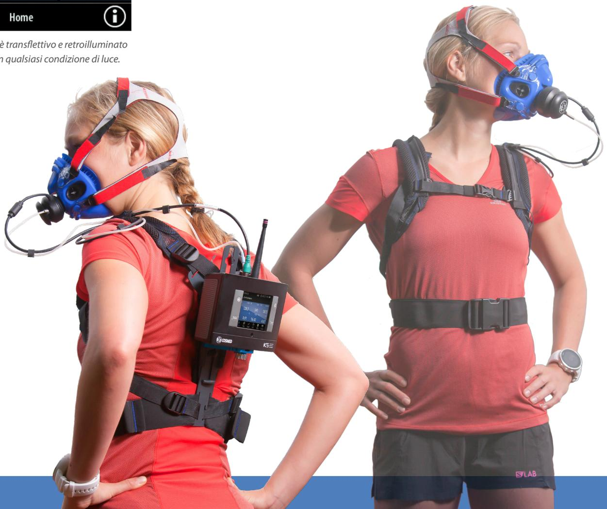
“K5 è conforme allo standard IP54. È stato concepito per l'uso all'aperto e garantisce massima protezione contro l'acqua (pioggia o sudore) e la polvere”
