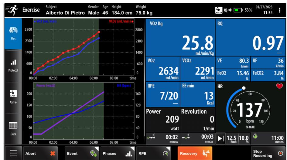
Q-NRG Max affiche en temps réel un tableau de bord clair avec tous les paramètres pertinents à surveiller. Les onglets sur la gauche permettent aux utilisateurs de passer d'un tableau de bord à l'autre.
