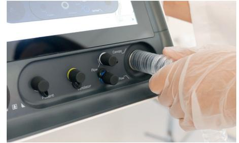
Pour les mesures sous canopy, il suffit de raccorder le tuyau du canopy à la pompe
