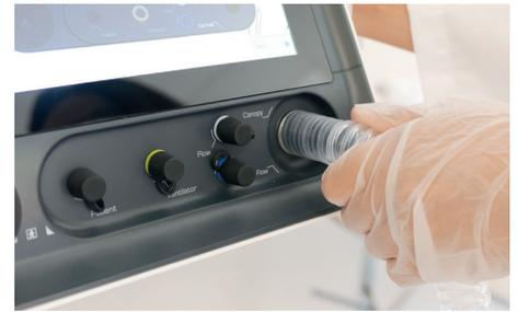
Las pruebas con el canopy son fáciles de configurar conectando el tubo corrugado al soplador.
