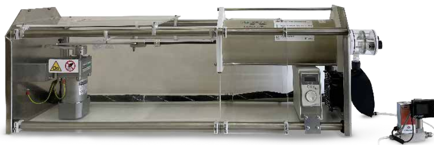
Il Simulatore Metabolico COSMED è uno strumento di verifica avanzato che simula lo scambio di gas e il pattern respiratorio umano per applicazioni sia cliniche sia di ricerca applicata
